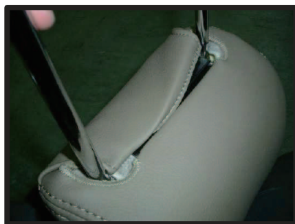
⑥カバーの取り付けは、プラスチックのフック同士で固定します。
