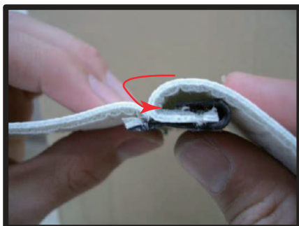
④平らなフックの方を生地を内側に巻き込む形で、カギ状のフックへと入れ込んでいきます。
