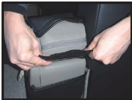
⑧入れ込んだ生地を背もたれとアームレストの間から引き出します。
