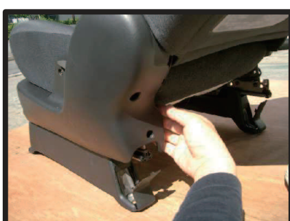
⑤ツメで固定されている部分があるので後ろ側から外していきます。
