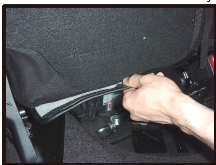
⑥③で引き出した生地を座面裏のシート本体に貼り付け固定します。
