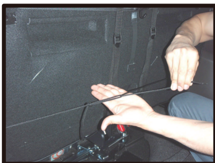
⑤カバーの側面から出ているヒモを結びます。片方のヒモで輪を作り、もう片方のヒモをその輪に通して、引き絞り固定します。ヒモは強く引きすぎると切れますのでご注意ください。
