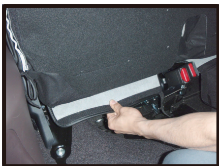
③座面を跳ね上げ、入れ込んだ生地を引き出します。
