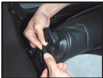
②外側の肩口にプラスチックの背もたれ固定用ロックがあります。そこをカバーに開けている穴から取り出します。まずはロック後ろ側の突起部分から取り出します。
