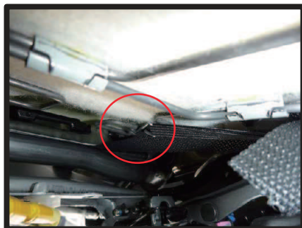
⑭S字フックは、座面下の金属部分に引っ掛け固定します。
