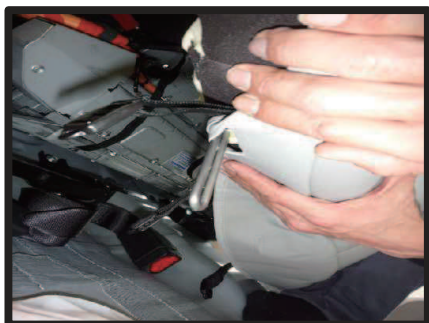
⑧シート下のボルトで固定されていた金属部分に、カバーの切り込み穴を通します。
