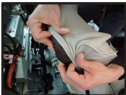
⑨シートの肩口にカバーをかぶせます。
