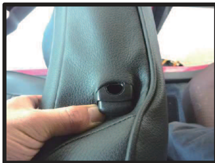
⑦ヘッドレストの台座を取り出します。図のように台座の片側のフチに生地をしっかりと入れ込みます。
