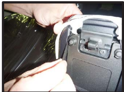
③ ①のオレンジ矢印のゴムを、図の隙間に引っかけるように通します。
