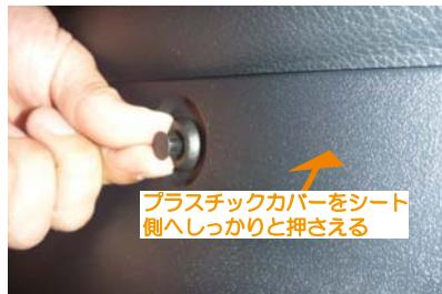
32 プラスチックカバーをシート側にしっかりと押さえて、穴位置を合わせてブッシュリベットの先端を入れ込みます。先端が引っ掛けた場合は無理に押し込まないようにご注意下さい。
