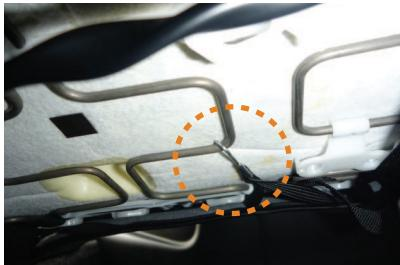
10 金属フックはシート裏の金属部分に引っ掛け固定します。
