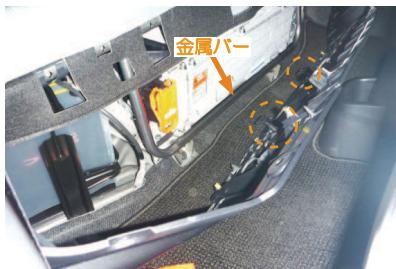
3 全てのプッシュリベットを外します。プラスチックカバー裏側の、図の丸印部分にフックがあります。フックは金属バーに引っ掛かっているので少し持ち上げるようにして手前に引くと、プラスチックカバーが外れます。
