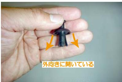
34 33番の作業でブッシュリベットの先端が引っ掛かり、何度も試しても入らない場合は先端部分が図のように開いてしまっている可能性があります。そのような時はゼロハンテープを用意して下さい。
