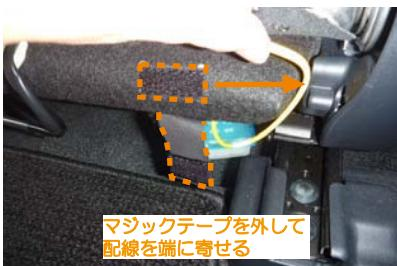
8 サイドエアバッグ装備車は黄色い配線を固定している、オレンジの点線で囲んだマジックテープの固定を外して、矢印の方向へ配線を寄せます。配線部分をかわして生地を引き出します。
