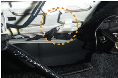
13 金属フックはシート裏の金属フレームに引っ掛けで固定します
