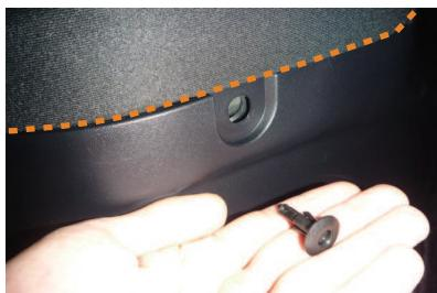
2 中心部分を押し込み、プラスチックカバーの図の点線部分を少し手前に引くとピンが外れます。ピンはプッシュリベットと言います。
