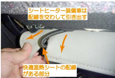
7 入れ込んだ生地をシート背面から引き出します。図はシートヒーター装備車です。シートヒーターが装備されている車は、図の配線部分をかわして生地を引き出します。
