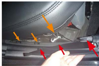
37 サイドのプラスチックカバーには側面側にツメが赤矢印の位置に3か所あります。車体側のオレンジ矢印の位置に受けが同じく3か所あります。ツメと受けの位置を合わせて元に戻します。ブッシュリベットでこちらも固定します。
