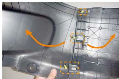
27 シートに戻す前にプラスチックカバーを3パートにばらします。こちらはつなぎ目で3か所クリップ留めされているので、つなぎ目部分を山折りに倒すようにするとクリップが外れていきます。作業は慎重に行って下さい。
