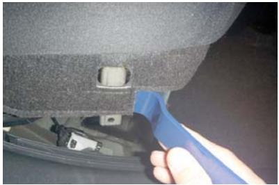
4 プラスチックカバーを外すとシートの両側面の生地が図のように固定されています。これは図の生地裏で**5番**の図にあるリベットピンで固定されています。リベットピンは内張りはがしや、クリッピングリムーバーなどの工具を使い外します。
