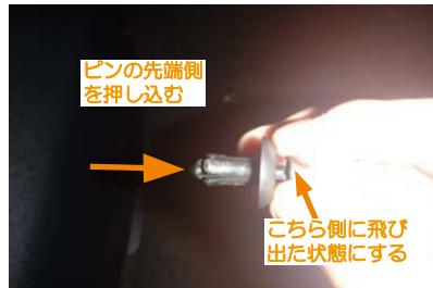
31 ブッシュリベットを元通りに固定します。ブッシュリベットは外すときは中心を押し込み外しましたが、戻す際は中心がピンから飛び出た状態にします。
