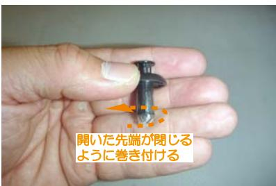
35 ゼロハンテープをブッシュリベットの先端に巻き付け、開いていた先端部分を図のようにテープで押さえて閉じます。こうすることにより、先端も細くなって入りやすくなり、固定する機能も損なわず使用できます。
