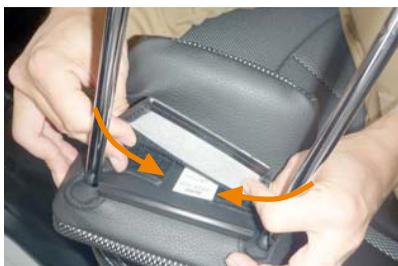
3 ヘッドレストの裏側で、両端にメスのマジックテープが付いている生地を内へ寄せながら、オスのマジックテープを貼り付けて固定します。
