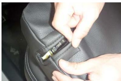
8 シートを固定する金具部分をかまして、マジックテープをシート本体に貼り付けて固定します。
