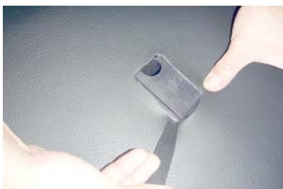
9 チャイルドシート固定用フックの位置にカバーの加工穴の位置を合わせます。ヘラなどを使用してシートとプラスチック部の隙間に生地を入れ込みます。
