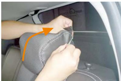
1 2列目ヘッドレストは、ヘッドレストの先端から後方へかぶせます。
