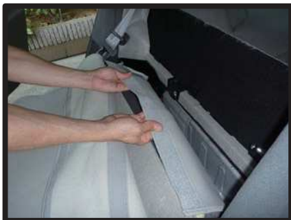
⑯ 背もたれを前に倒し、カバー前面の生地を引き出します
