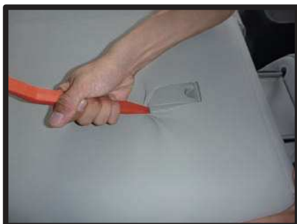
⑳ 背もたれ背面のチャイルドシート固定用バーをカバーの加工穴から取り出します。プラスチックのフチに生地を入れ込みます。
