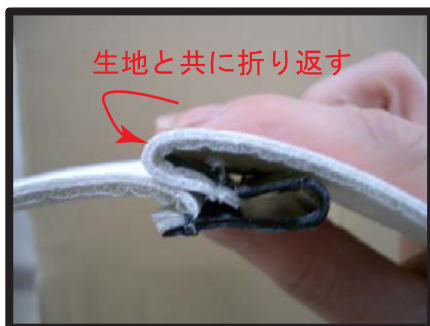
⑥プラスチックフックの固定方法は、 カギ状のフックに平らな方のプラス チックを、生地と共にはめ込み固定 します。
