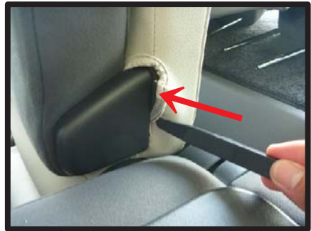
⑩シートの内側面です。図の隙間に生地を入れ込みます。
