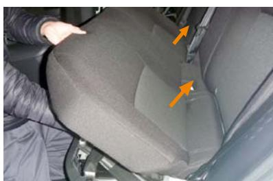
3 図はハイブリッド車の2列目座面です。フックを外すまではガソリン車と同様に外します。この後ハイブリッド車は、図の矢印裏辺りに手を入れて、その辺りを持ち上げながら、シートを少し手前に引きます。フックを外してすぐに手前に引いてしまうと、シート裏のクッションが車体側に引っ掛けたりシート裏の一部が破損しますのでご注意下さい。
