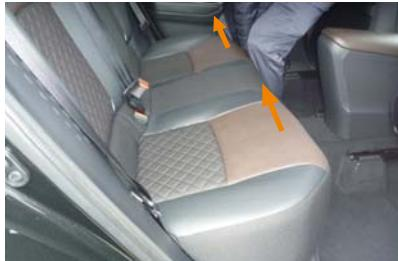
1 シートは図の矢印位置のシート裏辺りにある、2か所のフックで固定されています。シート裏のフックのすぐ横に手を添えて、片側ずつ真上に持ち上げるとフックが外れます。フックはかなり強固なものなので、しっかりと腰を入れて持ち上げるようにして下さい。フックのそば以外を持ってシートを持ち上げると、シートのクッションのみがめくれるので、ご注意下さい。
