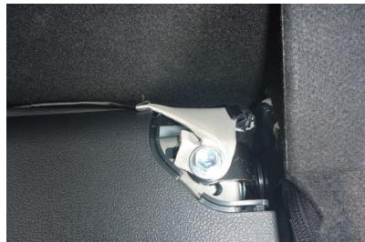
**16** 生地を挟み込みボルトを元通りに固定します。この際、生地が破れてしまうと固定が出来なくなるので、作業は慎重に行って下さい。ボルトを固定して**13番**で外したプラスチックカバーを元通りに固定します。プラスチックカバーのツメの位置に、生地が掛かっていると固定ができないため、その場合は生地をツメの位置に掛からないようにすらして、固定して下さい。
