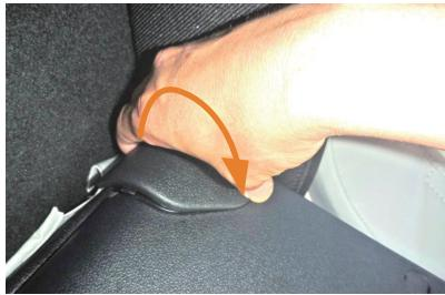
**13** シート中央の奥に、図のプラスチックカバーがあります。プラスチックカバーを手でしっかりと掴み、矢印の方向に後ろ側から前側に返すようにするとカバーのツメが外れて、カバーが外れます。
