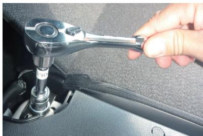
**14** プラスチックカバーを外すと、中にボルトがあります。ボルトをソケットレンチなどを使用して外します。ソケットは14mmを使用します。
