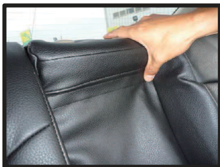
⑰アームレスト収納部のカバーにマジックテープを取り付けています。マジックテープをシート本体に貼り付け固定ませす。
