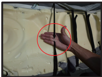
④カバー前後に付いているゴムを、付属のS字フックで固定します。
