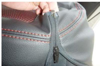
2 背面のファスナーを10センチ程度閉じておきます。完全には閉じてしまわないようにして下さい。
