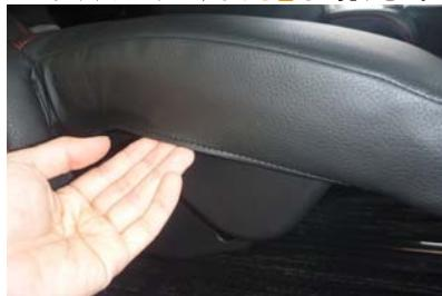
**17** ヘラなどを使用して部材を入れ込みます。入り込む隙間は本当に限られた位置にしかありません。カバーの装着や生地の引っ張り具合により、部材と入り込む隙間の位置にずれが生じます。その場合はカバーの装着を調整して下さい。
