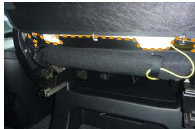
**14** **10番**で引き出した生地に付いているフックを固定します。シート背面下の図の点線部分にフックを引っ掛けて固定します。
