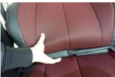
9 背もたれと座面の隙間に生地を入れ込みます。入れ込む生地にはフックが付いています。フックでシート地・カバーの生地を傷付けないようにご注意下さい。
