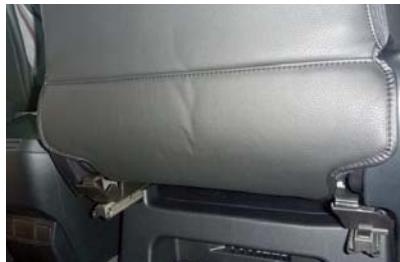
20 金属フックはシート裏の金属部分に引っ掛けで固定します。
