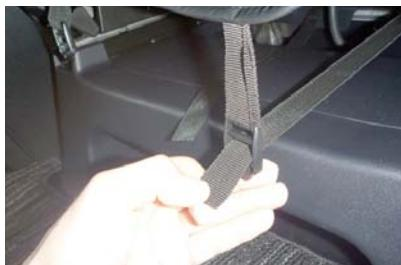
12 7番で入れ込んだベルトをシートの背面から引き出します。引き出したベルトを5ページ5番で引き出した生地に付いているバックルに通して固定します。
