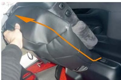
2 1番の部分を軸にして、シートのラインをかずれないように、カバーをシート全体にかぶせます。
