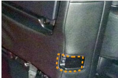
10 シート前側のレバー部分のフチに、中のネジを締めて生地を入れ込みます。
