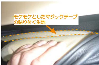
11 ハイブリッド車はシート内側のシート地に、カバーのマジックテープを直接貼り付けて固定します。
