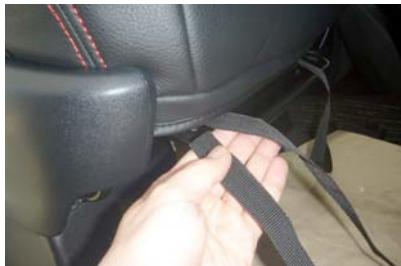
7 カバー前側に付いているベルトを、スライドレバーの上を通してシートの背面側から引き出せるように入れ込みます。
