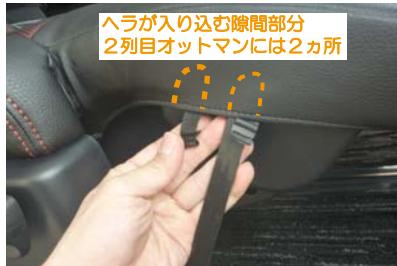
**16** オットマン側面の生地裏に、図のような小さい部材が付いています。こちらはオットマンのフチに図のようにヘラが入り込む隙間が一部分のみあるので、その隙間に部材を入れ込みます。助手席スーパーロングスライドシートの車は**18番**もご覧下さい。
