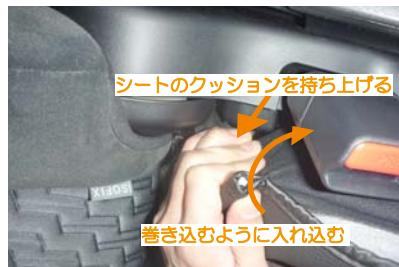
6 シートの付け根部分です。シートのクッションを少し持ち上げるようにして隙間を作ります。その隙間にカバーの端に付いている固定部材を、シートを巻き込むようにして入れ込み固定します。内側外側共に行います。
