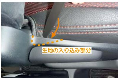
9 シート外側の付け根部分は隙間が大変狭くなっています。生地をプラスチック内側の矢印の方向へ向けて入れ込むことで、生地がきれいに入り込みます。
