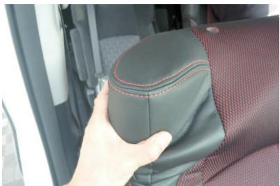
4 カバー背面のファスナーを開けて、カバーをかぶせます。始めにシート肩口に生地がしっかりと馴染むように、シートに密着させていきます。
