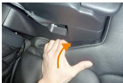
6 シート外側面の付け根の生地を奥へ入れ込み固定します。
