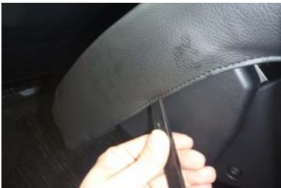
19 部材はヘラなどを使用してしっかりと入れ込みます。これによりカバー側面の生地の浮きなどが抑えられます。
