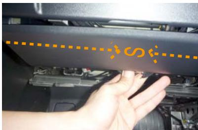
11 オットマンを跳ね上げた裏側をシートの前側から見た図です。図には写っていませんが、入れ込んだゴムをオットマンの内側から引き出してゴム同士を矢印方向へ引っ張り、金属フックでつなぎ留めます。
