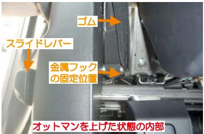
12 もう1本のゴムも9番同様に金属フックを取り付けて、オットマン付け根の内側にゴムを真っ直ぐに引っ張り、オットマン内部の金属部分に引っ掛けて固定します。図では固定位置が見えづらいですが、オットマンの動作に干渉しない位置に金属フックを固定して下さい。
