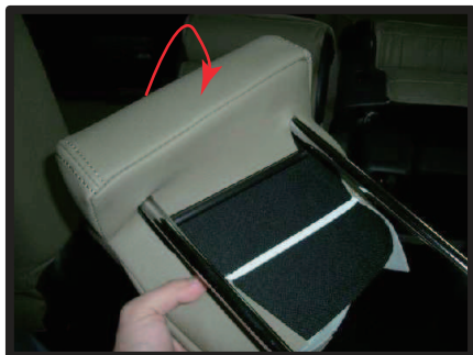
⑧ゴムの伸びを利用し、カバーを上へずらしていき、カバーをヘッドレストの上側からかぶせていきます。
