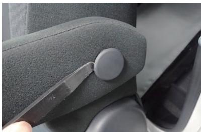
1 始めにアームレストを外します。図のプラキャップをヘラなどを使用して外します。
