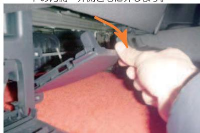
6 中央部の側面の固定を外すと、図のように中央のプラスチック部が開きます。この状態にすると12ページ10番の作業が容易に行えるようになります。
