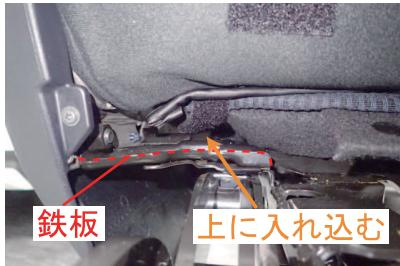
7 シートを後ろから見た際、左側に付いているマジックテープを、図の鉄板の上に通します。
