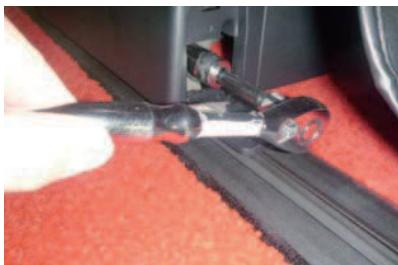
2 ふたを開けて中にあるボルトを、ソケットレンチなどで外します。ソケットは17mmを使用します。
