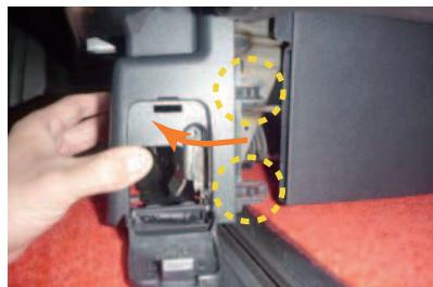
5 ふたを開けた状態で、開けたふた部分を掴み、矢印の方向へ慎重に引っ張ります。中央のプラスチック部とクリップ式のツメで固定されている部分が図のように外れます。ツメは○印部分に2か所あります。シートの内側・外側ともに外します。
