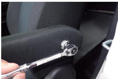
2 ソケットレンチなどを使用して、アームレストを固定しているボルトを外します（ソケット14mm）。
