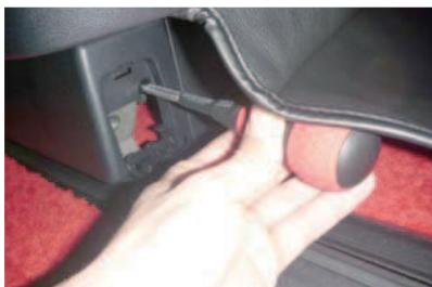
3 中にあるネジをドライバーを使用して外します。
