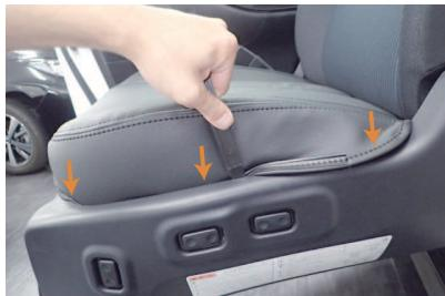
5 カバーの左右と前側に付いている固定部材を、生地と共にプラスチックカバーの隙間に入れ込みます。
