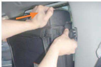
9 3列目シートを跳ね上げて、車体側にロックをする際、ロックが車体側まで届かない場合は、図のようにシートの角を押して固定するようにして下さい。
