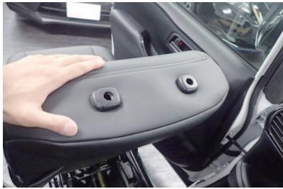
8 ヘッドレストの台座をカバーの加工穴から取り出します。
