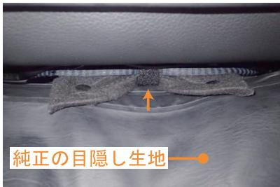
9 実際の中央部分は、図のように純正の生地と生地の隙間に、マジックテapeを通してします。
