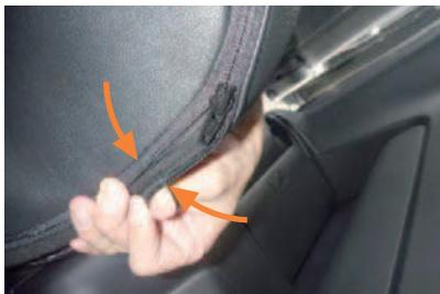
6 カバー外側面のファスナーを、生地を内へ寄せながら慎重に閉じます。ファスナーの端はカバーの内側へ入れ込みます。
