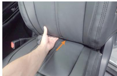
4 背もたれと座面の隙間に生地を入れ込みます。背もたれの角度を調節して、入れ込みやすい角度で作業を行って下さい。
