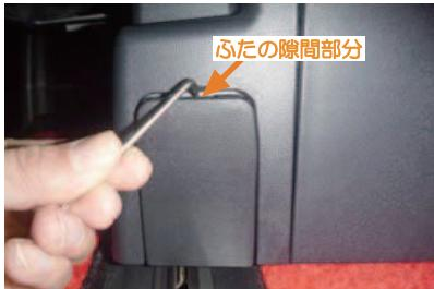
1 2列目座面下のレールの上部分にあるプラスチックのふたを開けます。細く先の尖ったものを上の隙間に差し込み、手前に引くとふたが開きます。ふたはシートの内側・外側にあります。
