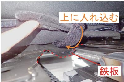
6 4番で引き出したマジックテープの内、中央に付いているマジックテープを、図の鉄板の上に入れ込みます。
