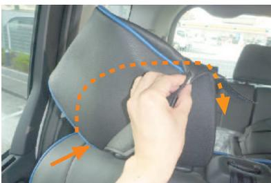
**8** 2列目サイドのヘッドレストは、ヘッドレストの片側（左下の矢印部分）のフチにカバーを引っ掛けるようにして、シート全体に慎重にかぶせていきます。固定方法は1列目ヘッドレストと同様です。
