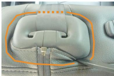
**28** 中央のシートベルトが出ている台座のフチに、ヘラなどを利用して生地とファスナーの端部分を入れ込みます。
