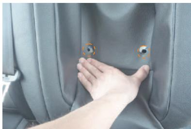
**21** アームレスト収納部に生地を馴染ませながら、カバーの加工穴とアームレストを固定するボルト穴の位置を合わせます。
