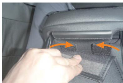
**3** ヘッドレストをシートから外します。ヘッドレスト底面で生地を内へ寄せながらマジックテープを固定します。
