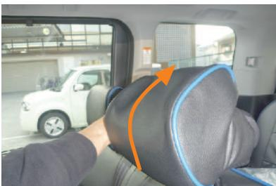
**9** 2列目中央のヘッドレストは、ヘッドレストの先端にカバーを引っ掛けるようにして、矢印方向へかぶせていきます。固定方法は1列目ヘッドレストと同様です。
