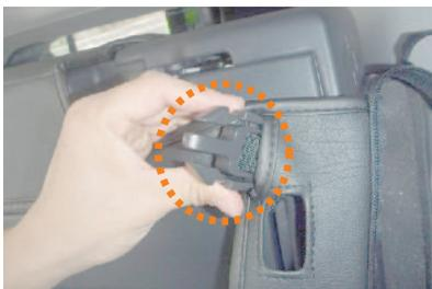
**9** シートを跳ね上げて、図の切込み穴からシートを跳ね上げた際に、シートを固定するベルトを通します。ベルトは間違っって長方形の穴に通さないようにして下さい。長方形の穴は通したベルトをシート側に固定する際のロック部分に位置を合わせます。
