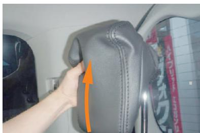
**1** 3列目両サイドのヘッドレストは、図のようにヘッドレストの先端にカバーを引っ掛けるようにして、下から上かぶせます。
