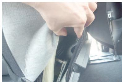
**23** シート背面のカバーとシート表皮をめくりながら、13ページ3番でアームレストを外した時と同様に、ソケットレンチなどを使用してアームレストを固定します。
