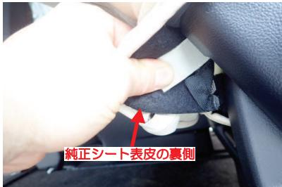
13 引き出したマジックテープを直接シートに貼り付けて固定します。
