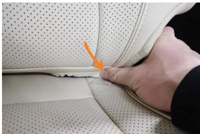
7 両サイドのマジックテープをシートに固定する際は、図のようにマジックテープの付け根辺りを、シートの隙間に矢印方向に押し込むようにすると、作業がしやすくなります。
