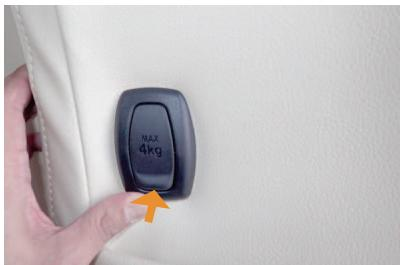
25 次に下のツメを引っ掛けるようにコンビニフックの下側を押し込みます。
