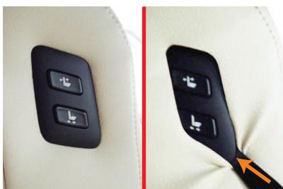
9 背もたれ内側面にあるパワーシートスイッチとシートの隙間に、ヘラ等を使用してカバーの生地を入れ込みます。
