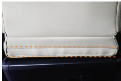
10 カバー背面下部に付いているマジックテープを、シートに直接貼り付け固定します。
