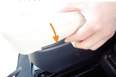
14 シート内側のカバーに付いている固定部材を、生地と一緒にシートとプラスチックパーツの隙間に入れ込みます。
