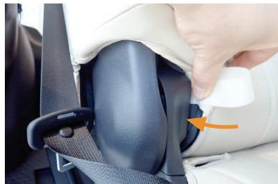
11 シート外側の付け根部分です。カバーにはマジックテープが付いています。マジックテープをシートとシートの軸の隙間にに入れ込みます。
