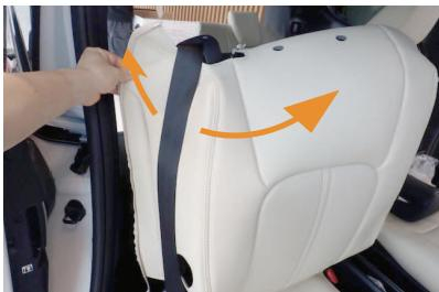
1 カバー背面のファスナーを開いて、シートの肩口から出ているシートベルトの内側にカバーを通します。
