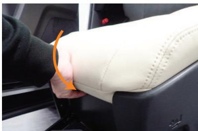
9 シート先端のラインに、カバーを馴染ませるようにします。
