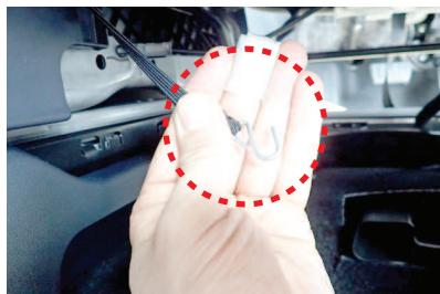
17 引き出したゴムに付属の金属フックを取り付けます。
