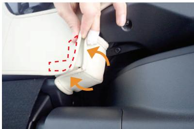
8 シートを跳ね上げて入れ込んだ生地の端に付いているマジックテープと、シート裏のカバーに付いているマジックテープを固定します。
