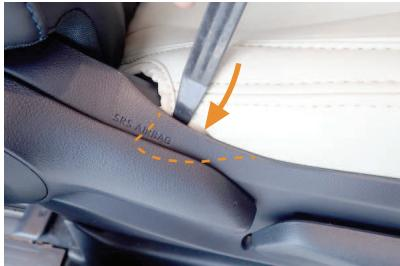
13 シート外側の付け根の生地を、シートとプラスチックパーツの隙間に入れ込みます。付け根部分は隙間が大変狭くなっています。ヘラなどを使用して、生地を矢印の方向へ入れ込むようにすると生地が入れ込みやすくなります。
