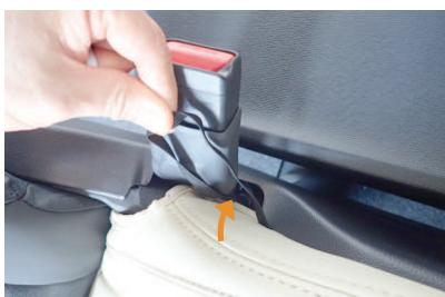
15 シートベルトのバックルが出ている付け根部分のカバーに、ゴムが付いています。ゴムをバックルの内側に通して、図の隙間からシート裏へ入れ込みます。
