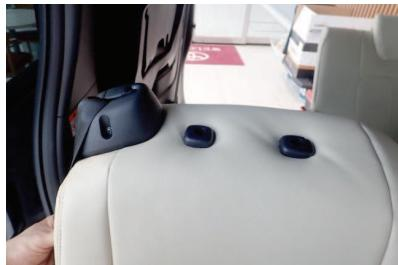
4 ヘッドレストの台座をカバーの加工穴から取り出します。
