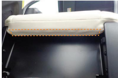
10 カバー先端に付いているマジックテープをシート下に直接貼り付けて固定します。
