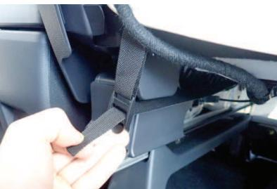
21 引き出したベルトを**8番**で引き出した生地に付いているバックルに通して固定します
