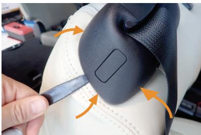
3 シートベルトが出ているプラスチックバーとシートの隙間に生地を入れ込みます。ヘラなどを使用してシワや弛みがなくなるように生地を入れ込みます。
