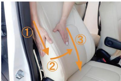
13 ①～③の順番に、カバー側面の生地を引き下げながら中央へ寄せて、中央で余った生地を下へ撫で下ろします。シートの下に余った生地を12番と同様にシート裏から引き出して、生地をシートに密着させていきます。
