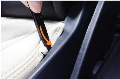
7 シートの付け根部分の生地も、シートとプラスチックカバーの隙間に入れ込みます。付け根部分は隙間が狭くなっていますのでヘラ等を使用して、生地を矢印方向へ入れ込むようにすると、作業がしやすくなります。
