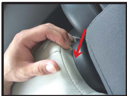
⑩シート背面です。シート付け根部分に生地を入れ込み
