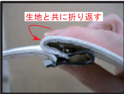
⑥プラスチックフックの固定方法は、 カギ状のフックに平らな方のプラス チックを、生地と共にはめ込み固定 します。
