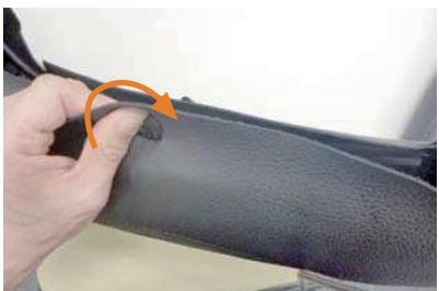
9 アームレスト裏のツメに、カバーの切込み穴を引っ掛けるようにして通します。
