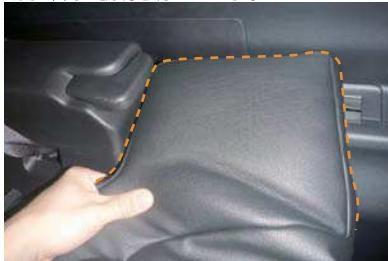
1 始めに外側に突起している図のシート部分にカバーをかぶせます。シートを少し斜めに跳ね上げると隙間が出来てカバーをかぶせやすくなります。シートの先端までしっかりとかぶせます。
