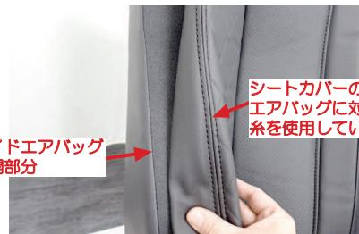
3 サイドエアバッグの展開部分と、シートカバーのSRSサイドエアバッグに対応した縫製糸を使用している縫い目の位置（以降SAB対応の縫い目部分）を合わせます。
