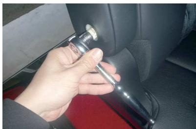
3 ソケットの長さが40mm以上あるものを利用して中のナットを外します。ソケットは12mmを使用します。ナットを外すとアームレストがシートから外れます。
