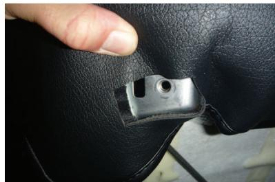
16 アシストグリップ・バックボードを固定する穴の部分を、カバーの加工穴から出します。この状態でバックボードを元通りに固定します
