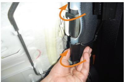
14 カバー背面の両端も、シート表皮を固定しているフックの上からカバーのフックを引っ掛けで固定します。（2カ所ずつ）
