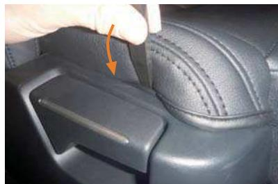
4 シートのラインにカバーを合わせて、シート外側面のフチに生地を入れ込みます。
