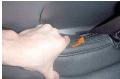
6 外側面のシート付け根部分に生地を入れ込み固定します。
