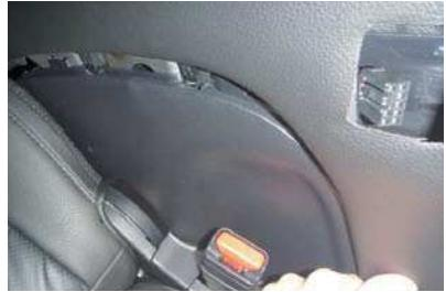
21 中央側を合わせたらシート側のツメの位置を合わせます。そしてもう一度19番で合わせたシート側付け根のツメの位置が、ずれていいかを確認して下さい。
