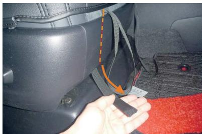
7 カバー前側に付いているベルト3本を、シートとプラスチック部の隙間を通してシート裏から引き出します。
