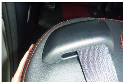
**4** シートベルト台座部分は図のようになります。ヘッドレストの台座も加工穴から取り出します。
