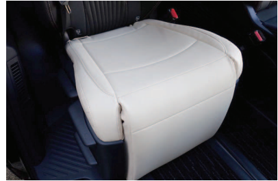
23 カバーを全て固定出来たら、オットマンをゆっくり収納して、内側の固定部材などに引っ掛からないか確認して下さい。何か引っ掛かるような感じがあれば、オットマン内側の、ゴムとマジックテープのベルトの固定位置を見直して下さい。
