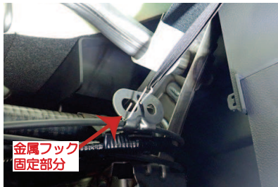
20 シート内側のオットマンの付け根部分です。外側と同様に、ゴムとマジックテープのベルトを固定します。シートの内側は、金属フックをオットマンの奥にある、図の金属部分に引っ掛けて固定して下さい。
