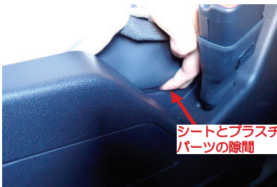
21 シート内側の後ろ側です。こちらも外側と同様に、シートの裏側にマジックテープを直接貼り付けて固定しますが、外側とはシートの形状が異なります。図のシートとプラスチックパーツの隙間に生地を入れ込むようにします。
