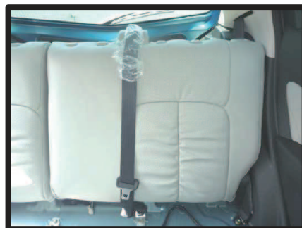
⑮カバーのラインを整えて、2列目6：4分割シート、助手席側背もたれの完成です。 運転席側、2列目一体型シートも形状は異なりますが、同様の固定方法
